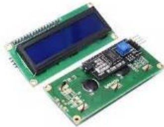
Gambar 3. LCD 16x2 dengan I2C
